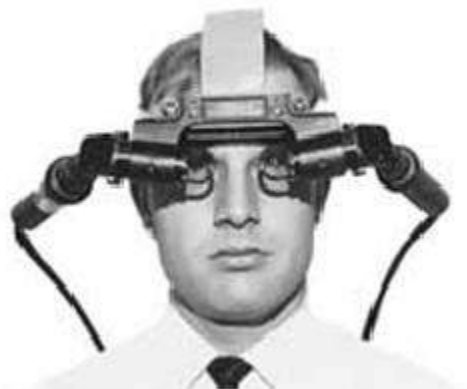
Figura 3: Head-mounted display desenvolvido por Ivan Sutherland. Fonte: http://www.sun.com/960710/feature3/ivan.html
